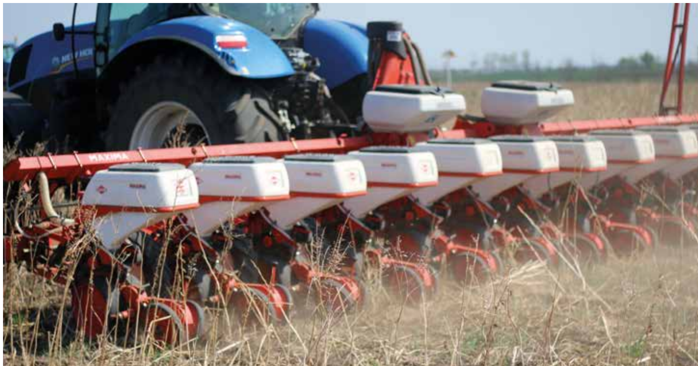
Direktvetés egy direktvetésre nem alkalmas Kuhn Maxima vetőgéppel egy Hatvan melletti takarónövényes táblán (a szerző felvétele)
